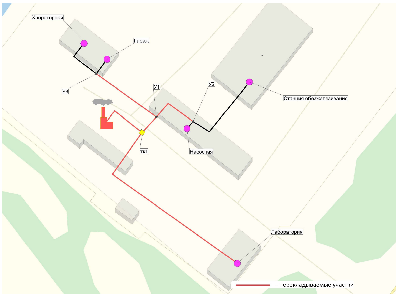
Рисунок 5-379. Схема перекладки тепловых сетей от котельной «Водозабор»
