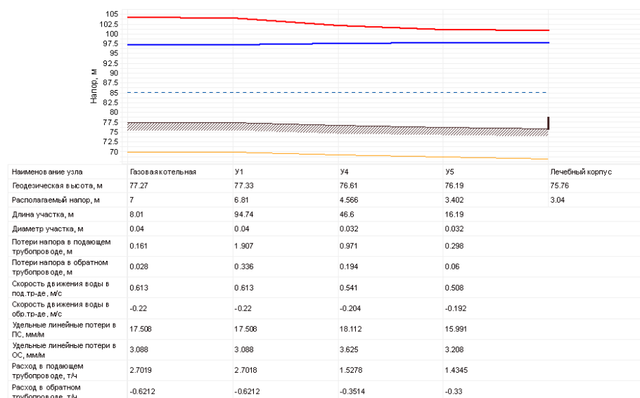
Рисунок 1-138. Фактический пьезометрический график сети ГВС от котельной «Борский ПТД» до удаленного потребителя: «Лечебный корпус»
