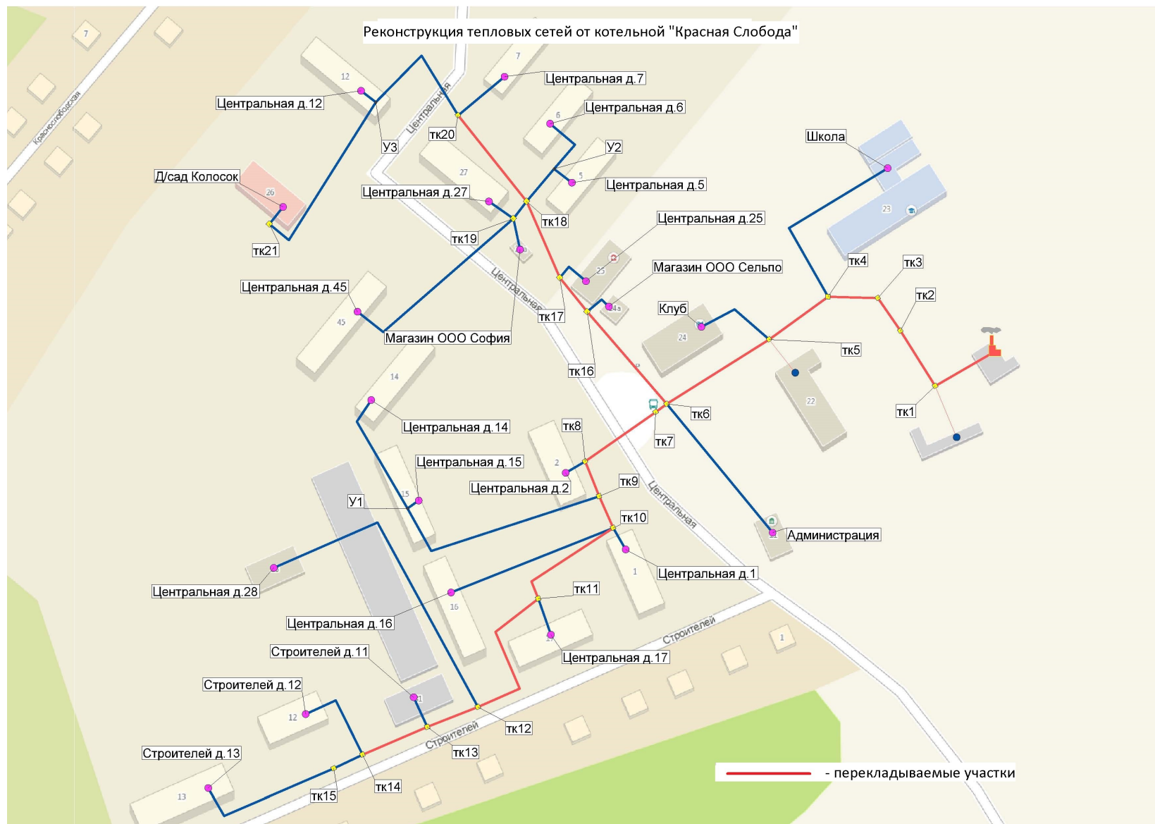
Рисунок 5-362. Схема перекладки тепловой сети от котельной «Красная Слобода»
