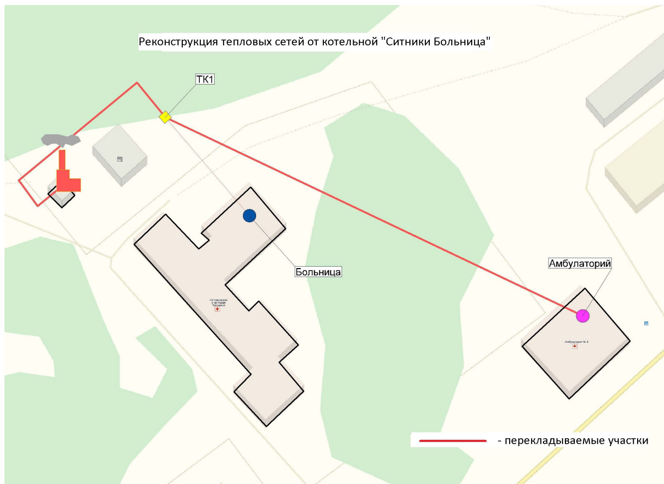
Рисунок 3-269. Схема перекладки тепловой сети от котельной «Ситники Больница»
