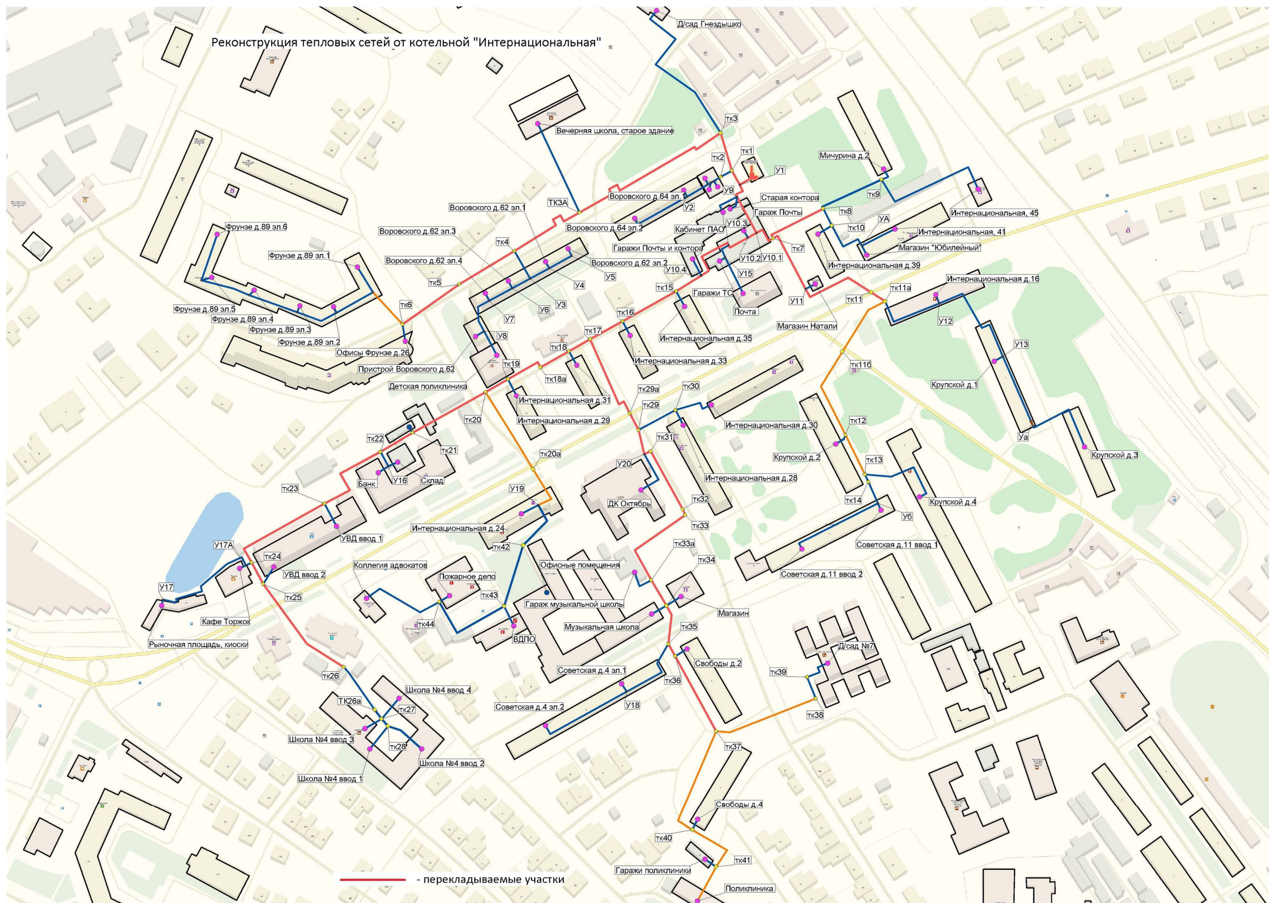
Рисунок 3-243. Схема перекладки тепловой сети от котельной «Интернациональная»
