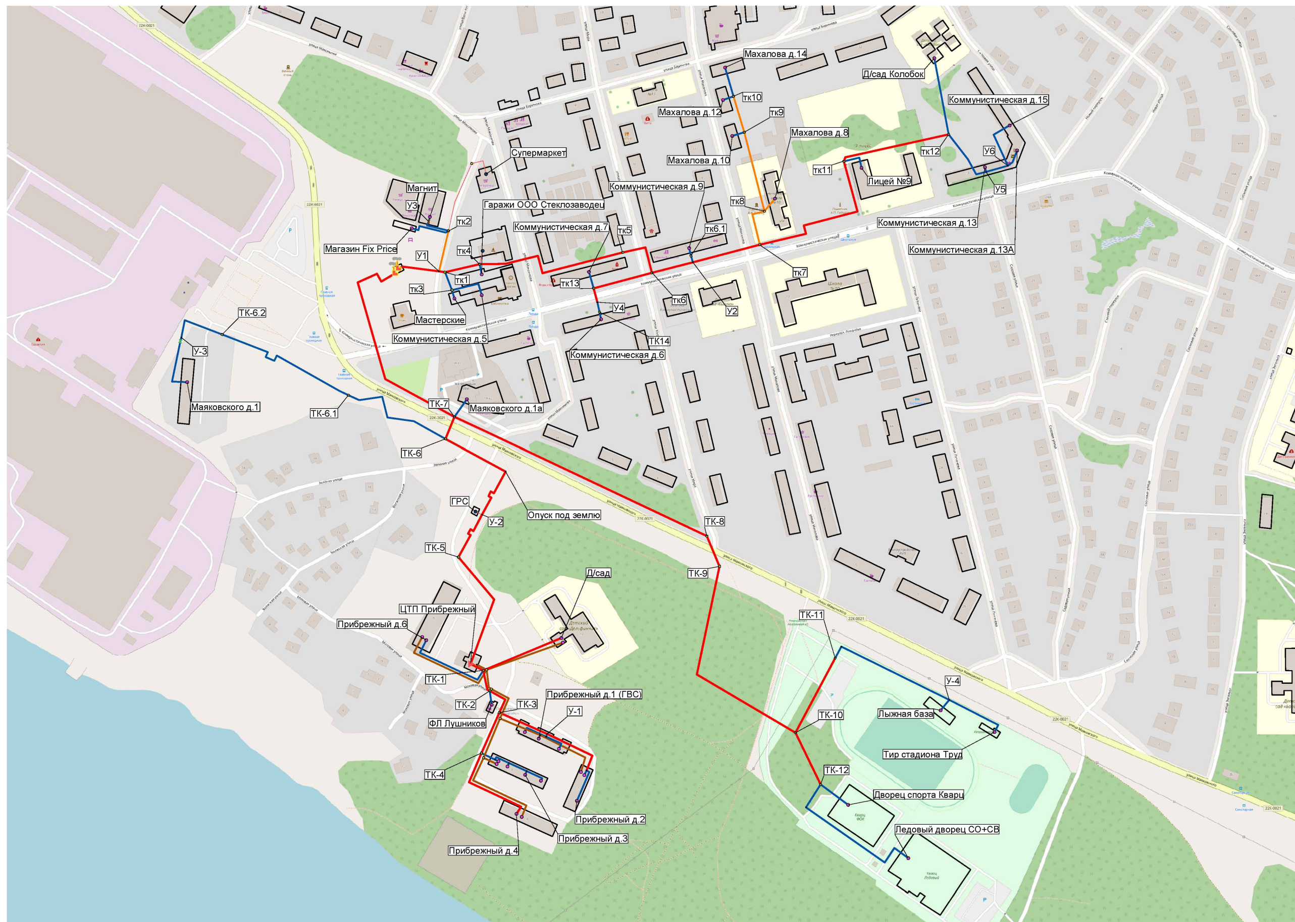
Рисунок 3-215. Схема перекладки тепловой сети от котельной «Алмаз»
