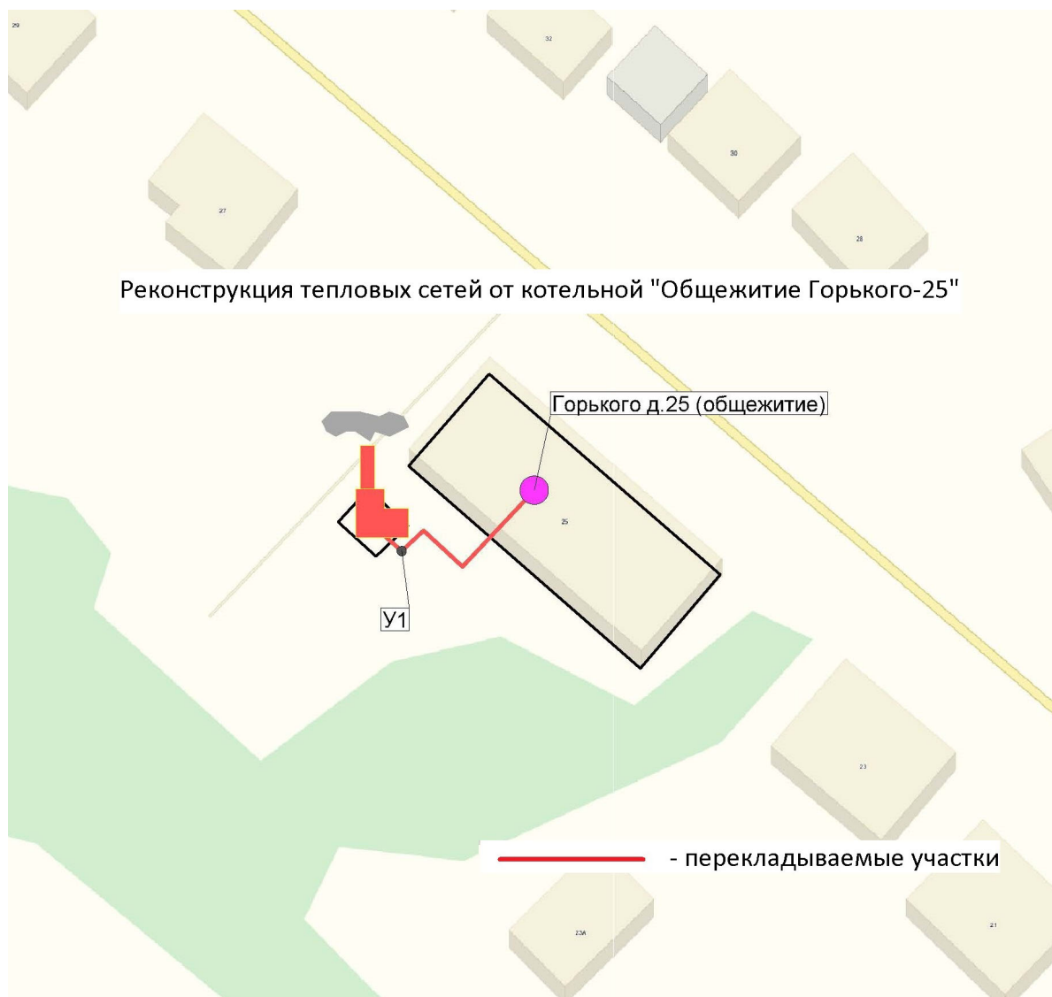
Рисунок 3-241. Схема перекладки тепловой сети от котельной «Общежитие Горького-25»
