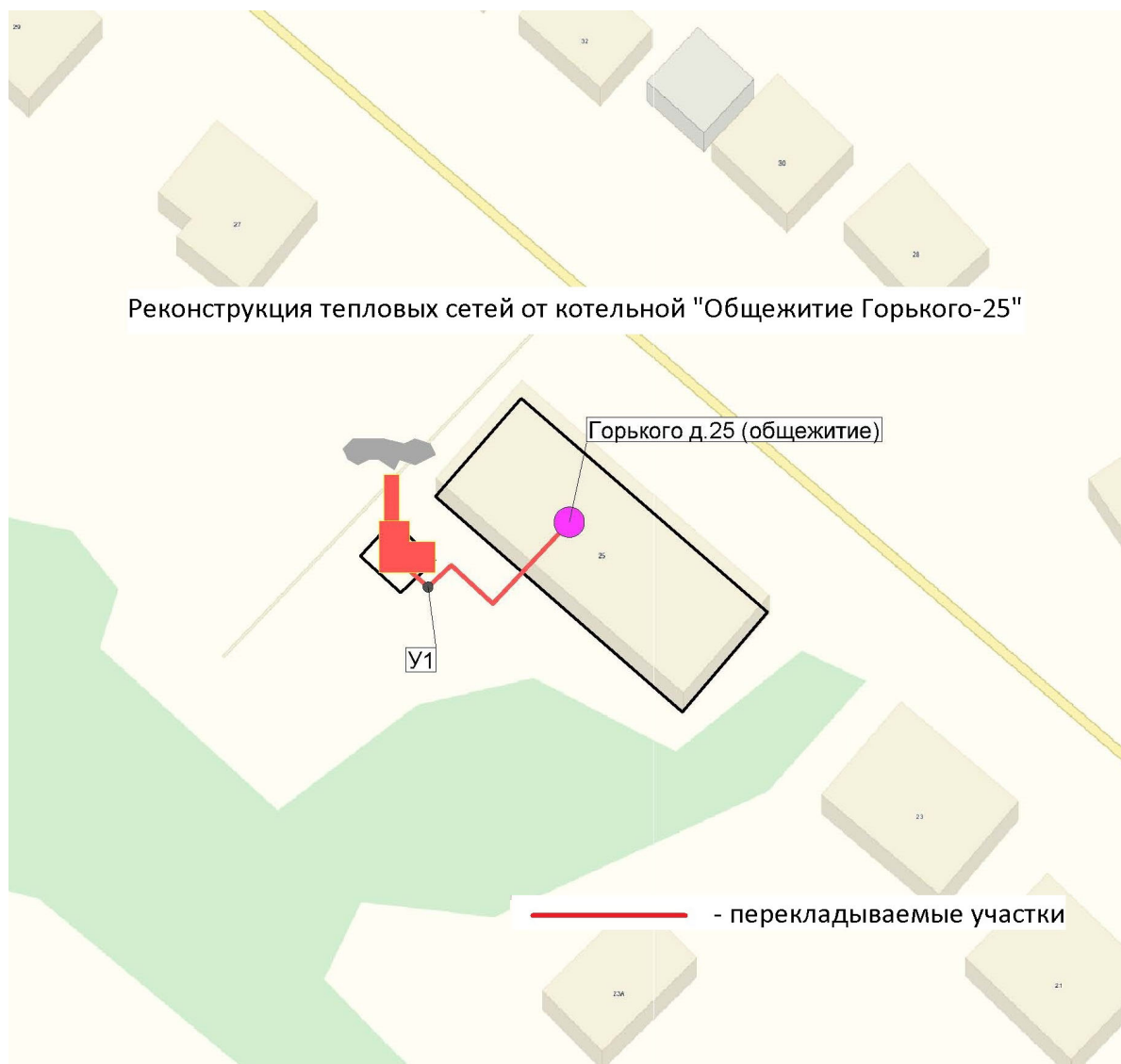
Рисунок 5-337. Схема перекладки тепловой сети от котельной «Общежитие Горького-25»
