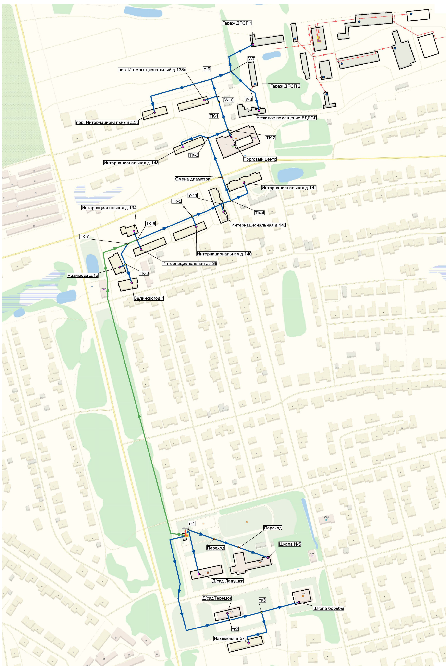
Рисунок 1-86. Схема тепловых сетей от котельной «Нахимова»
