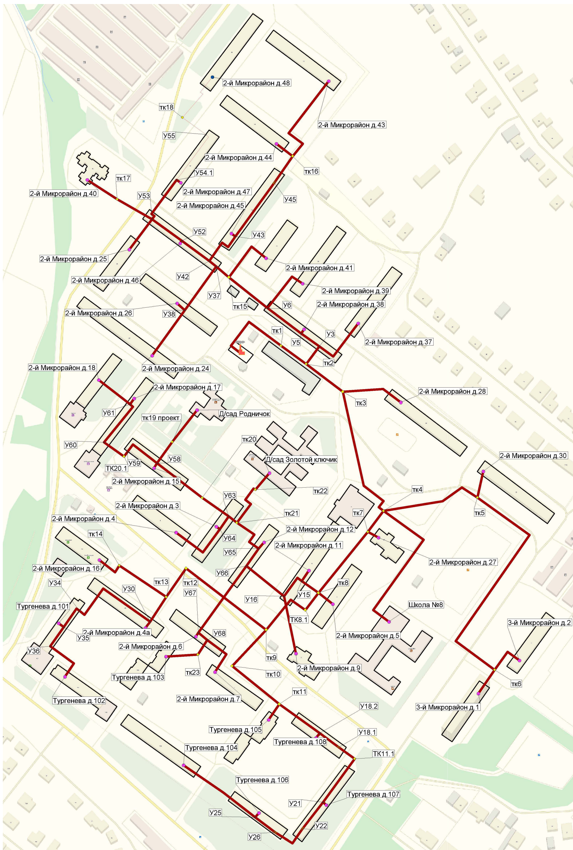
Рисунок 1-162. Схема сетей ГВС котельной «2-й микрорайон»
