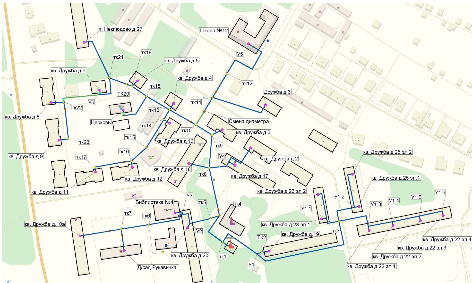
Рисунок 1-129. Схема тепловых сетей отопления от котельной «Дружба»
