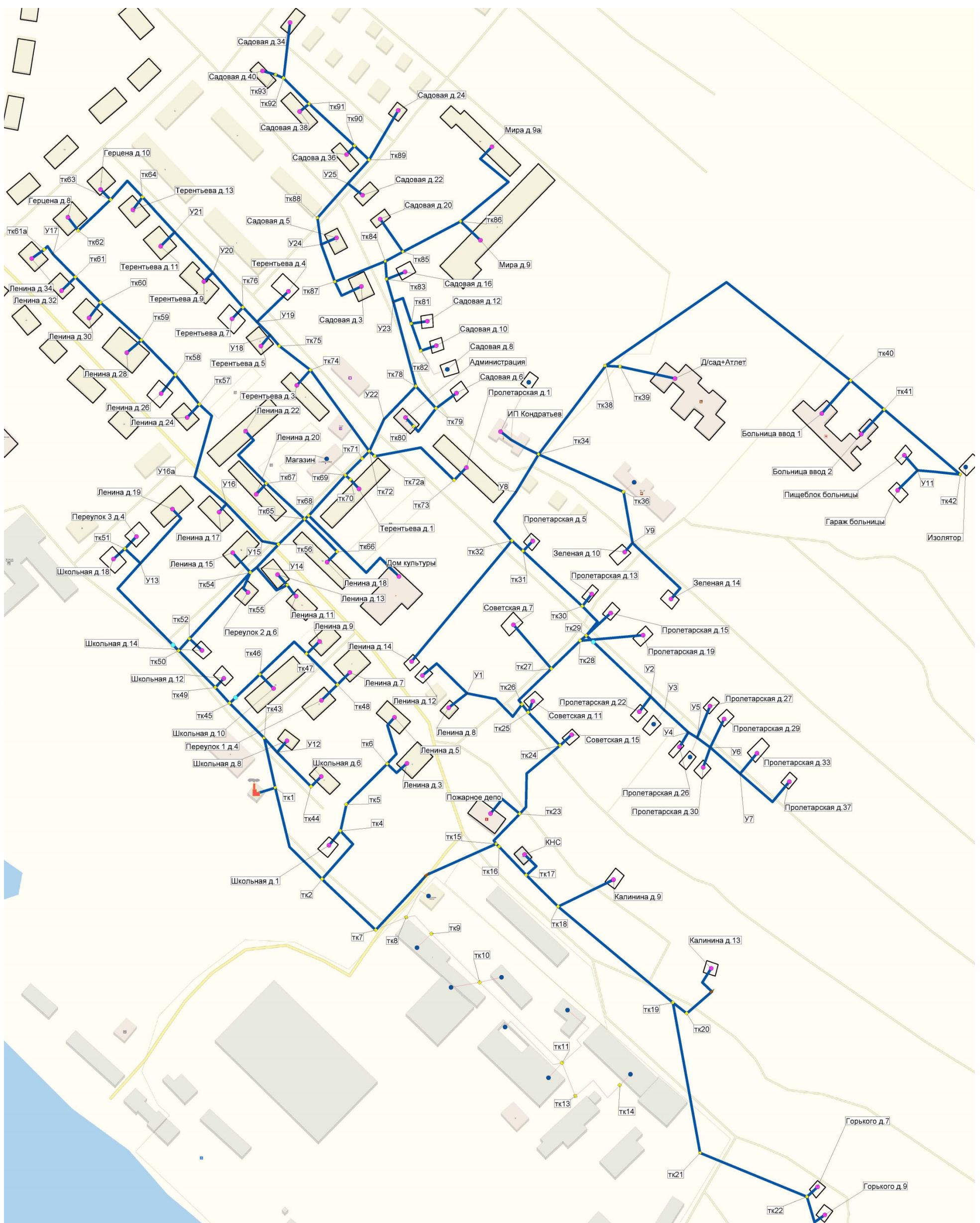
Рисунок 1-100. Схема тепловых сетей от котельной «ППК Школьная»
