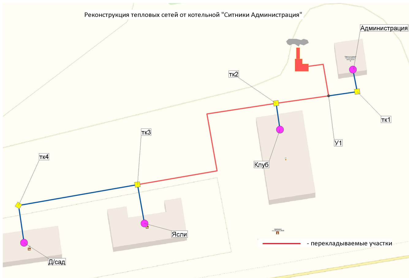
Рисунок 3-271. Схема перекладки тепловой сети от котельной «Ситники Администрация»
