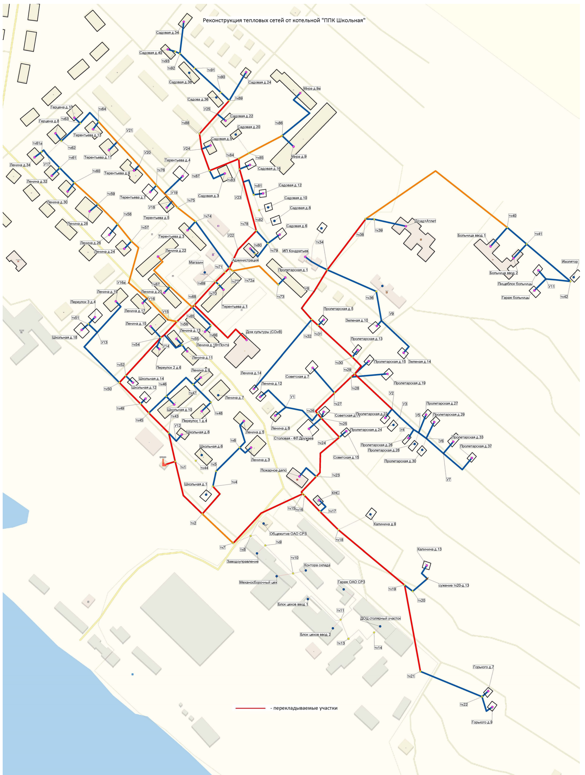
Рисунок 5-349. Схема перекладки тепловой сети от котельной «ППК Школьная»
