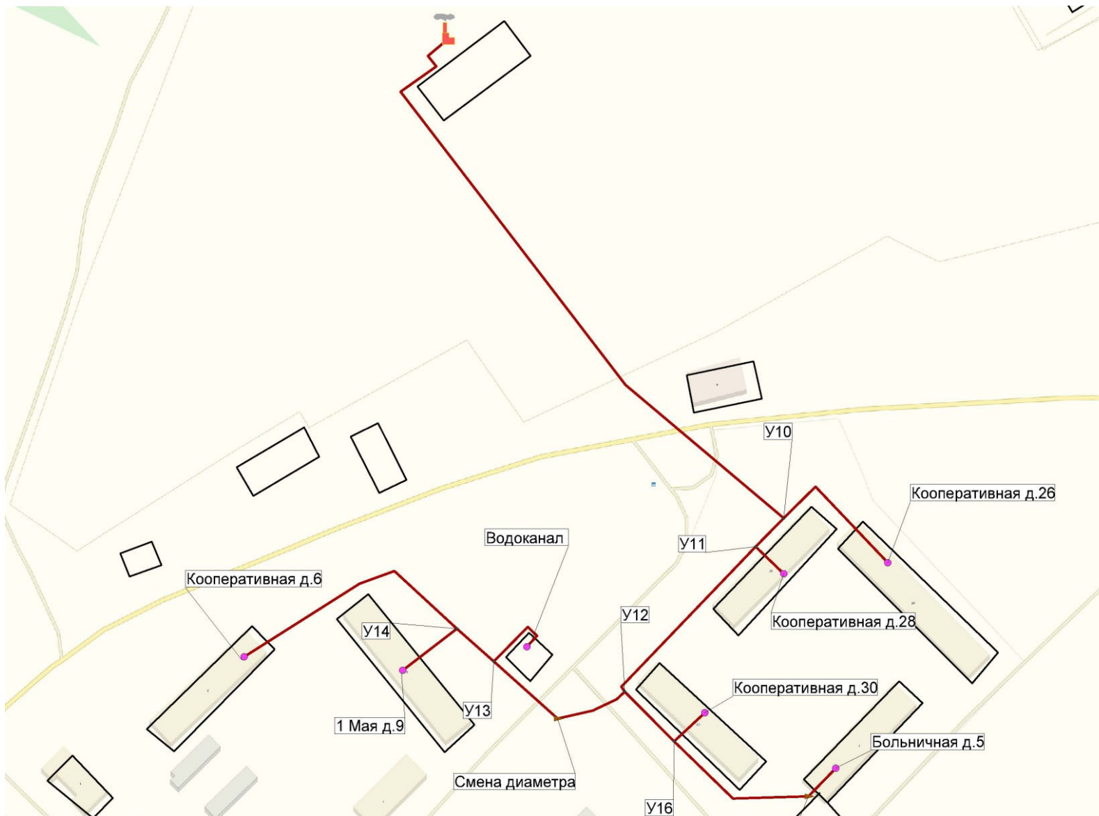
Рисунок 1-144. Схема сетей ГВС от котельной «Б. Пикино»
