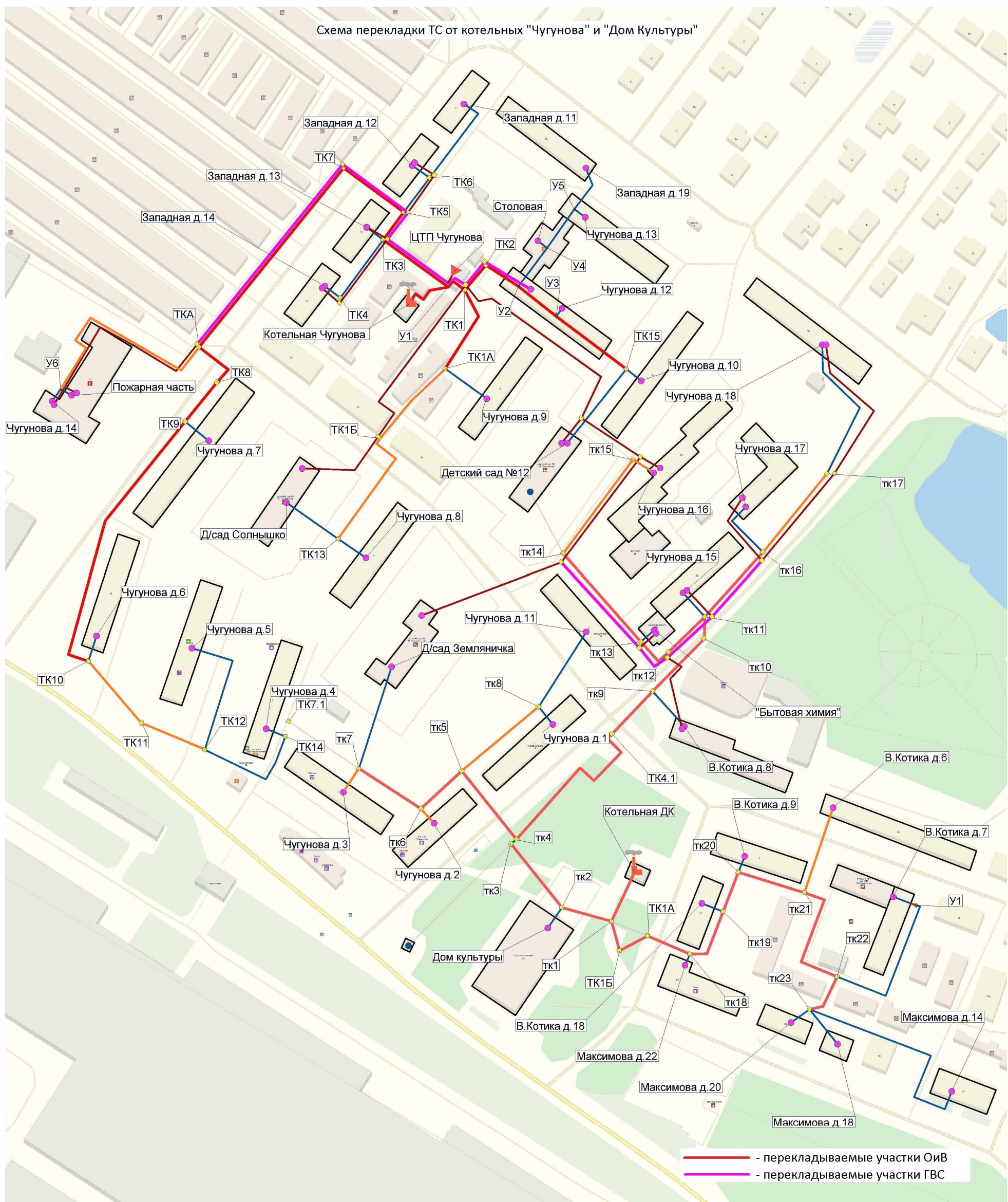
Рисунок 5-320. Схема перекладки тепловой сети от котельных «Чугунова» и «Дом Культуры»
