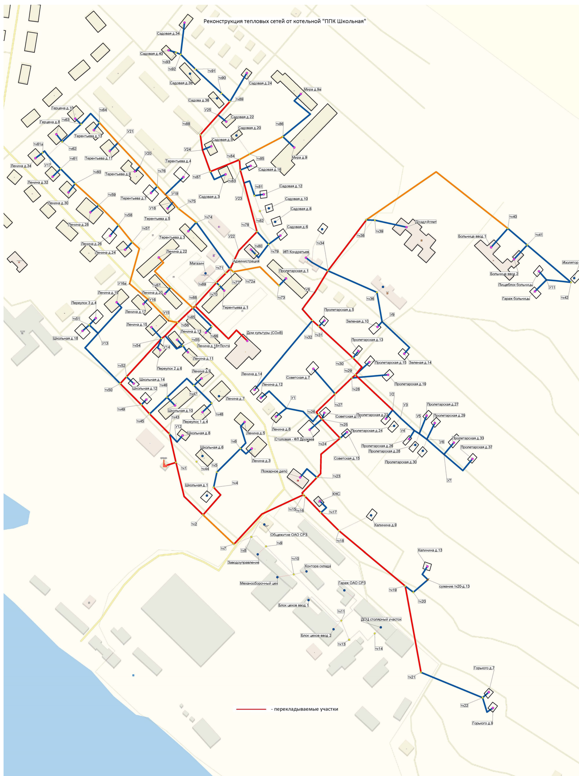
Рисунок 3-253. Схема перекладки тепловой сети от котельной «ППК Школьная»
