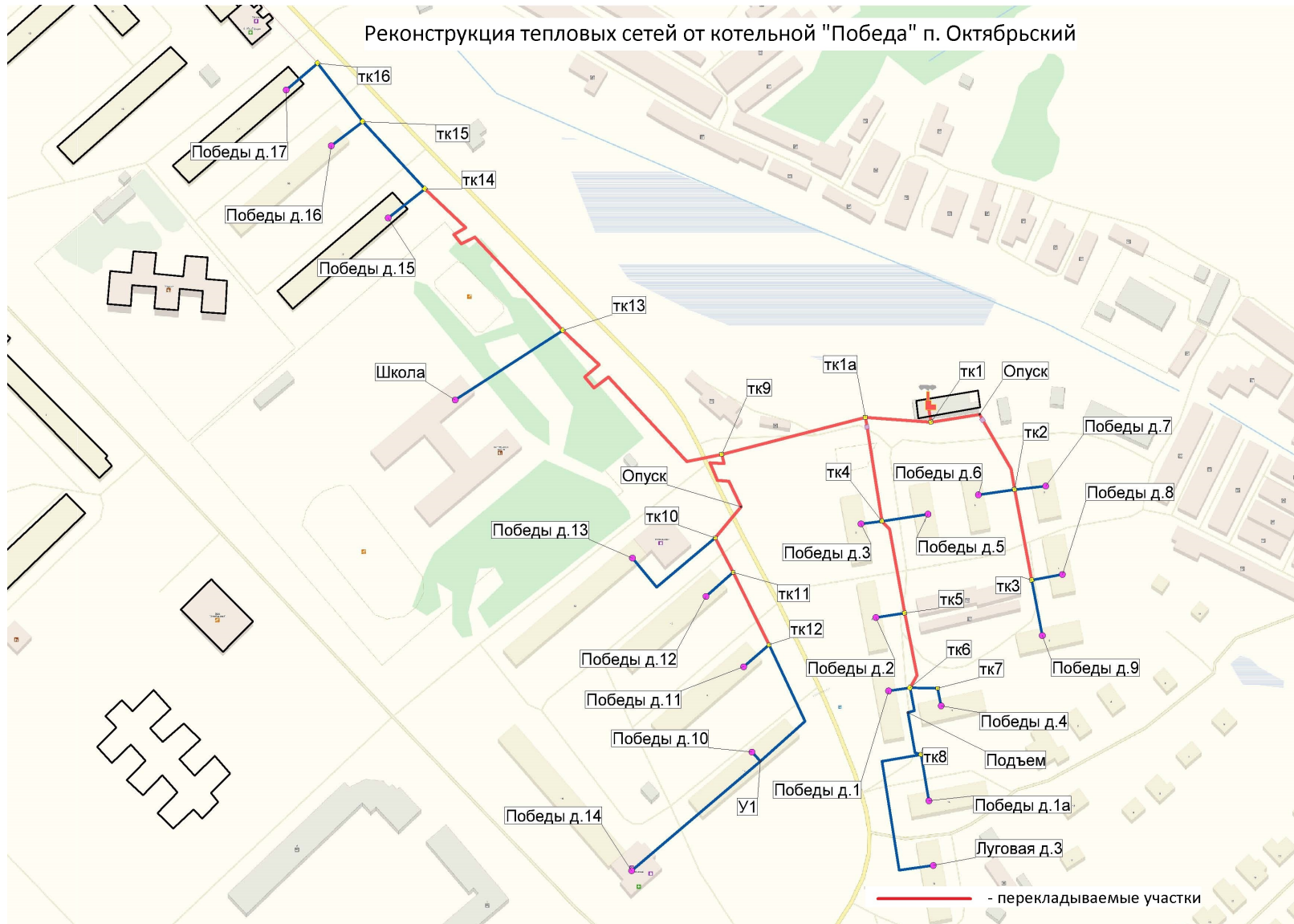
Рисунок 3-264. Схема перекладки тепловой сети от котельной «Победа»
