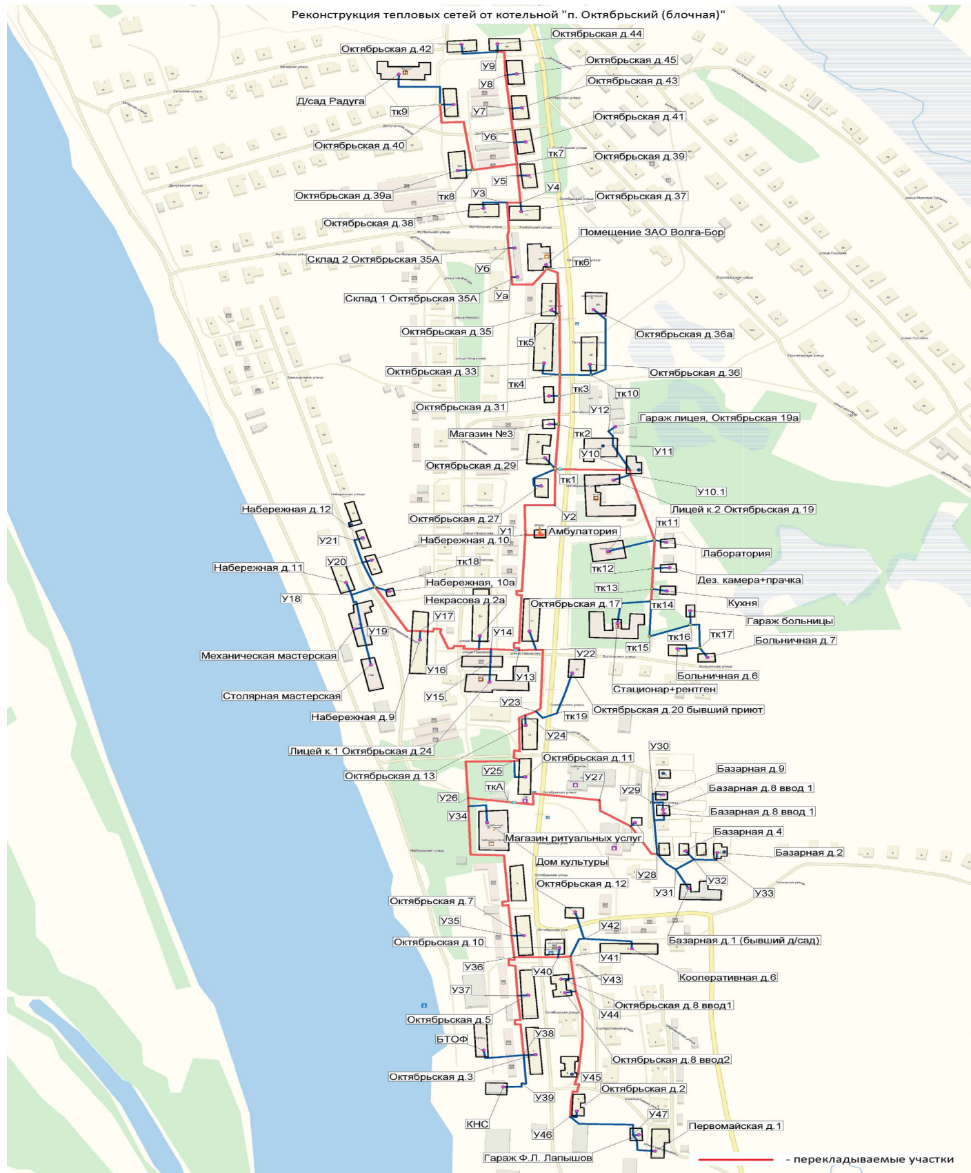
Рисунок 5-331. Схема перекладки тепловой сети от котельных «Октябрьский»
