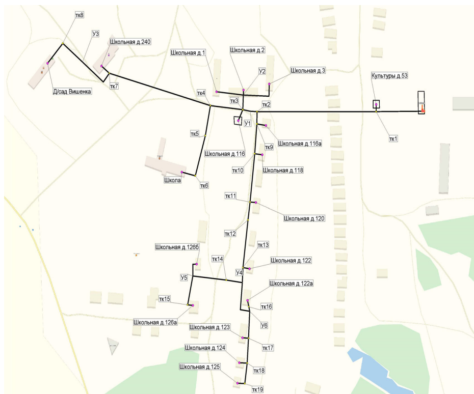
Рисунок 1-69. Схема тепловых сетей от котельной «Плотинка»
