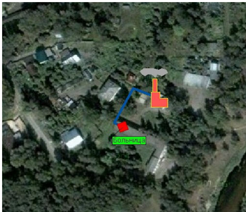
Рисунок 1-185. Схема тепловой сети с. Кантаурово (больничная котельная)
