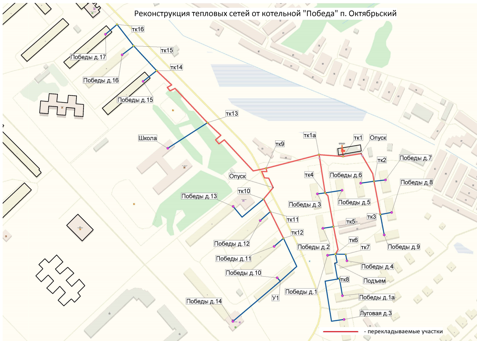
Рисунок 5-360. Схема перекладки тепловой сети от котельной «Победа»
