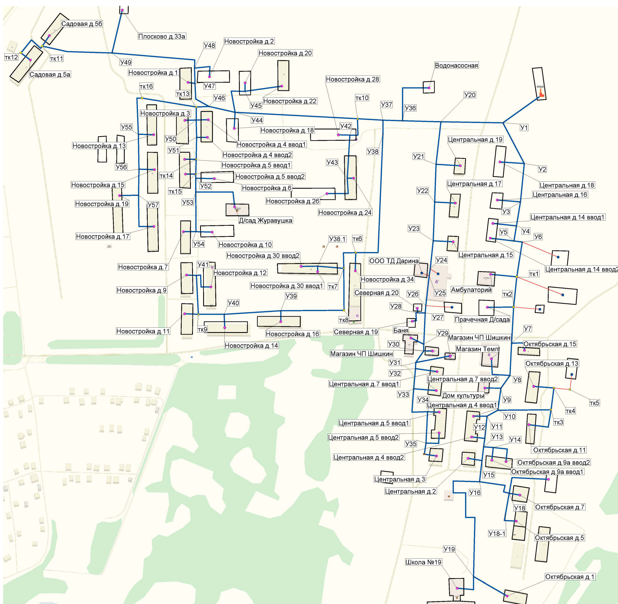
Рисунок 1-117. Схема тепловых сетей от котельной «Железнодорожный»
