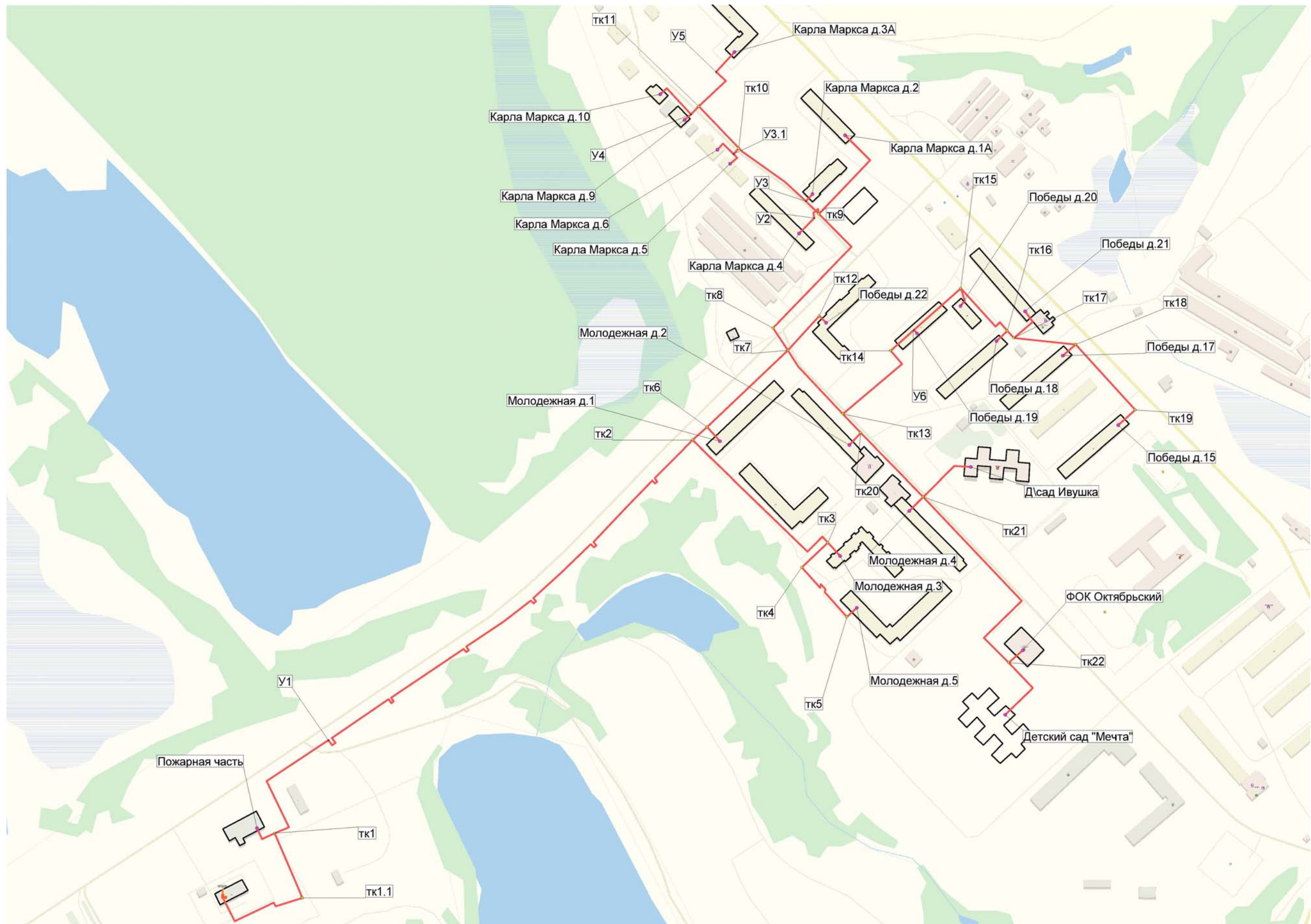
Рисунок 195. Схема сетей ГВС от котельной «Инженерный центр»
