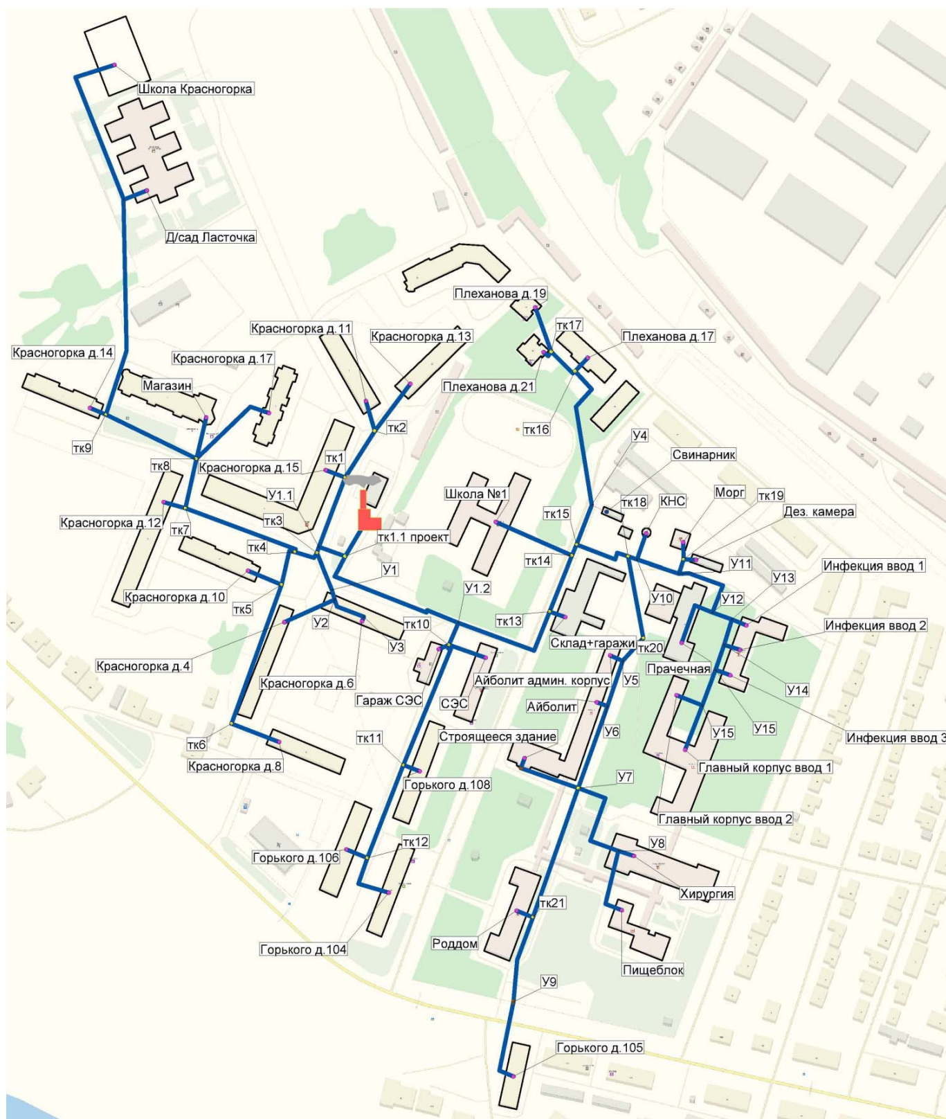
Рисунок 126. Схема тепловых сетей отопления от котельной «Красногорка»
