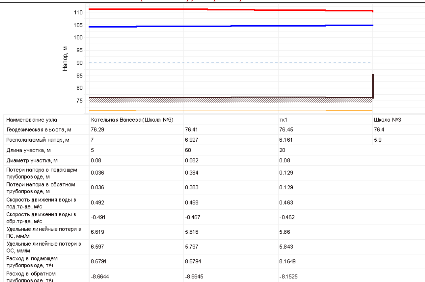
Рисунок 2. Фактический пьезометрический график тепловой сети от котельной «Ванеева» до наиболее удаленного потребителя «Школа №3»
