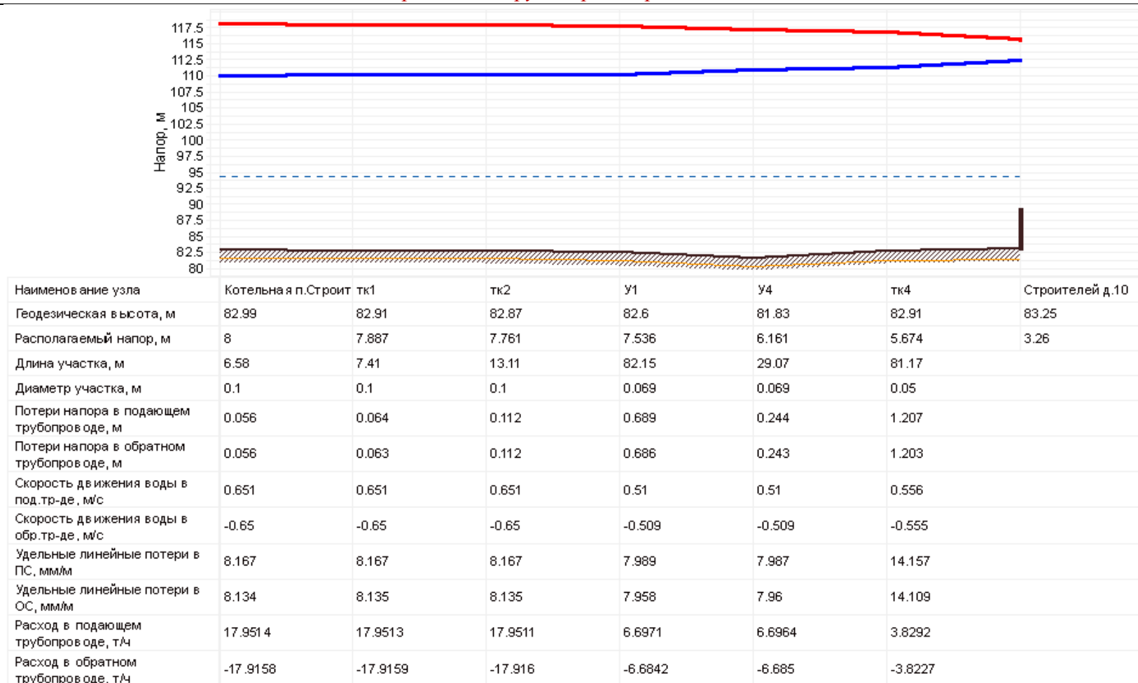
Рисунок 98. Фактический пьезометрический график тепловой сети от котельной «Строителей» до удаленного потребителя: ул. Строителей, д. 10
