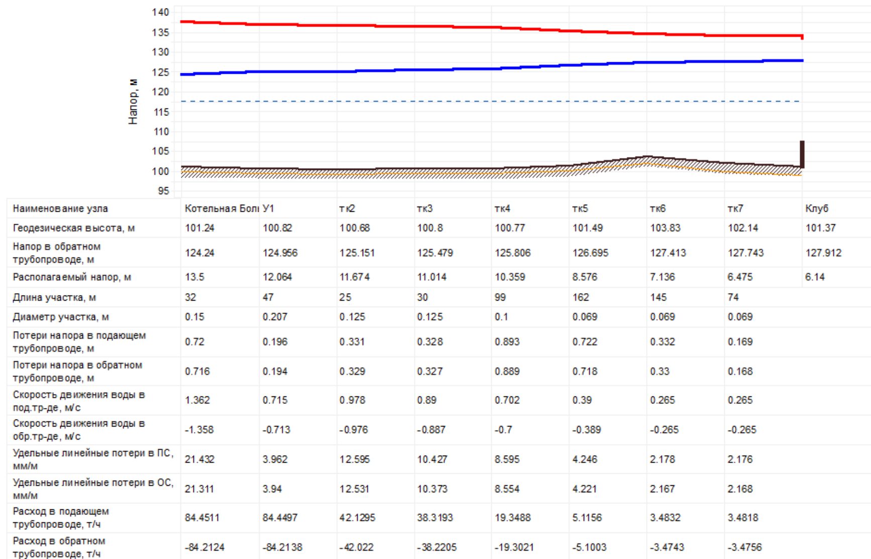
Рисунок 92. Перспективный пьезометрический график тепловой сети от котельной «Большеорловское» г. Бор до удаленного потребителя «Клуб»
