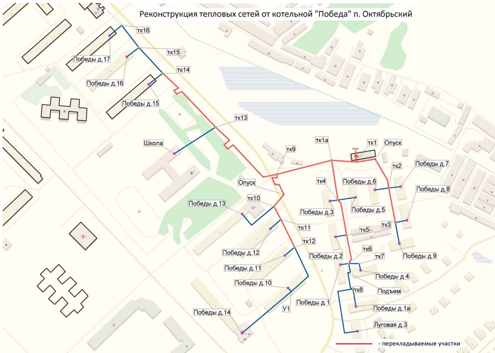
Рисунок 50. Схема перекладки тепловой сети от котельной «Победа».
