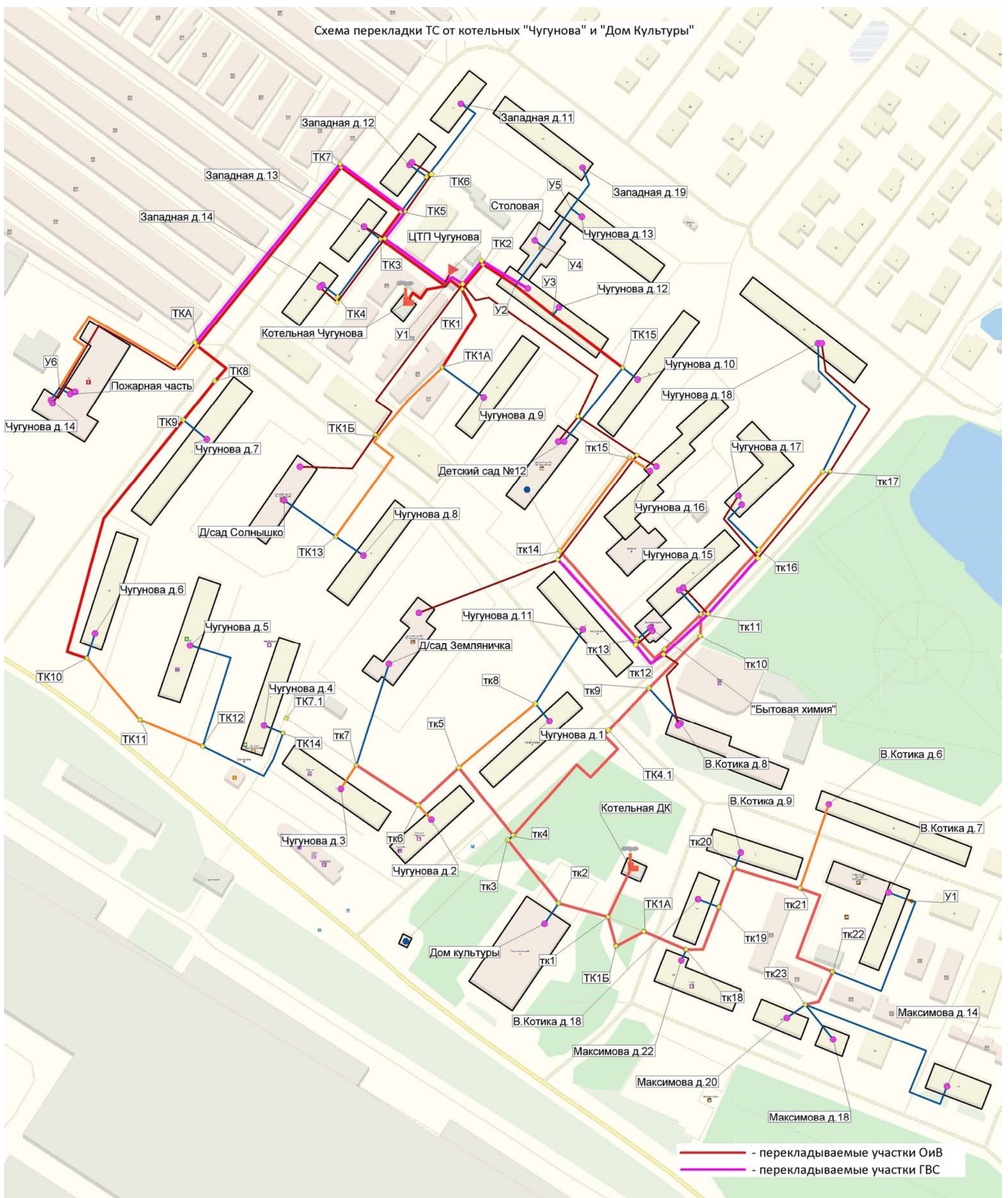
Рисунок 10. Схема перекладки тепловой сети от котельных «Чугунова» и «Дом Культуры».
