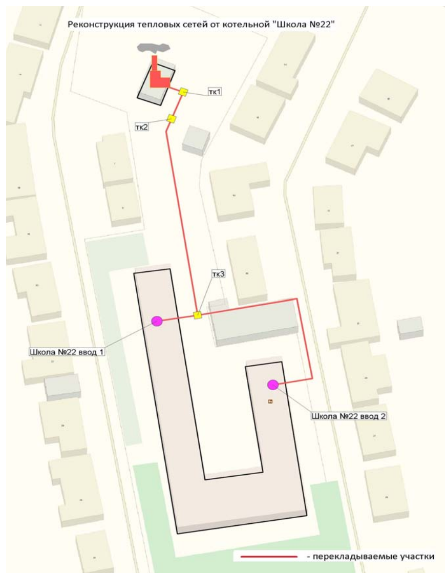
Рисунок 23. Схема перекладки тепловой сети от котельной «Школа 22».
