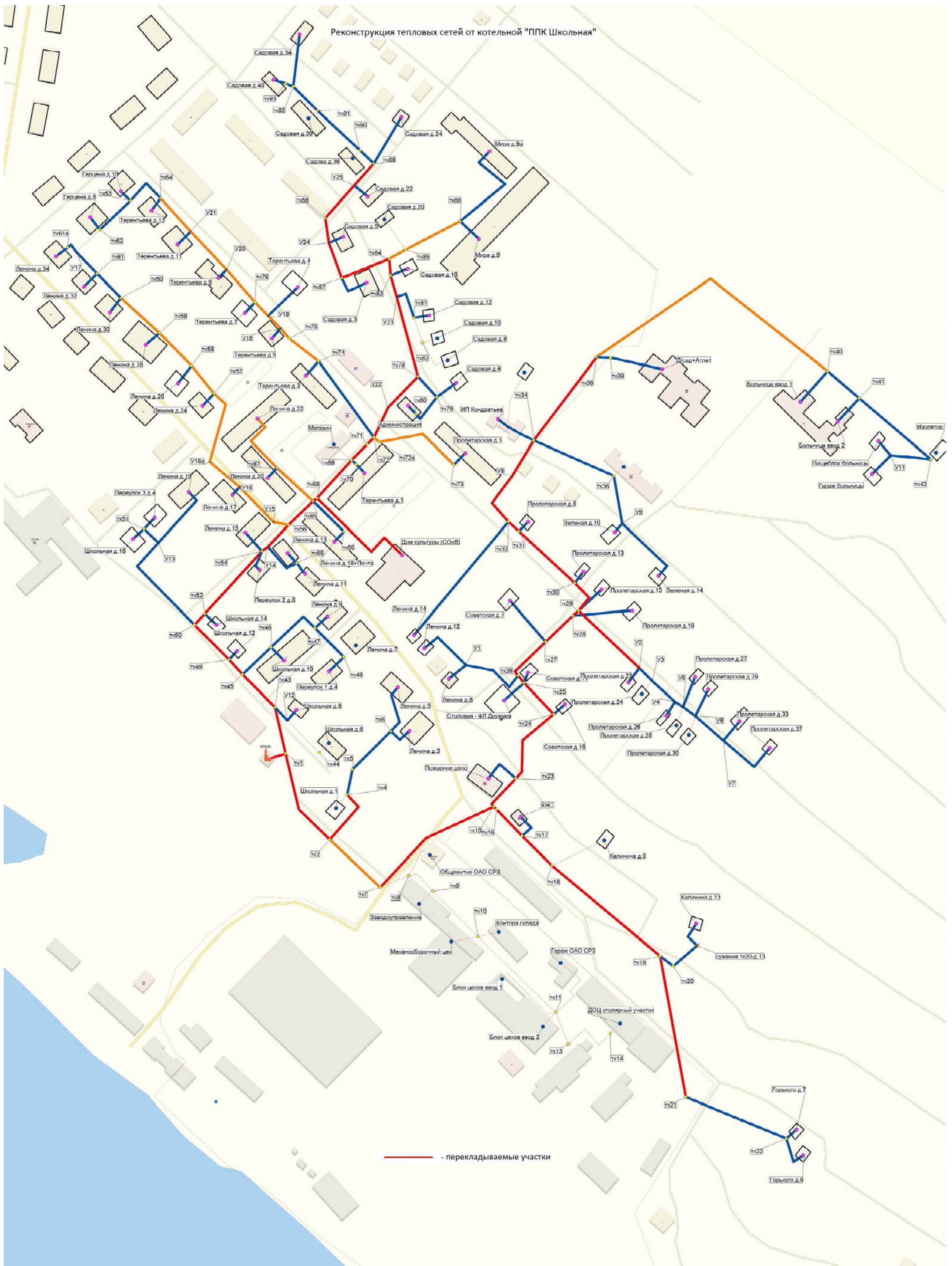
Рисунок 39. Схема перекладки тепловой сети от котельной «ППК Школьная».
